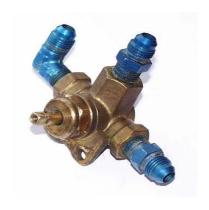
FIG. 2 FUEL SELECTOR VALVE EI-CIZ
